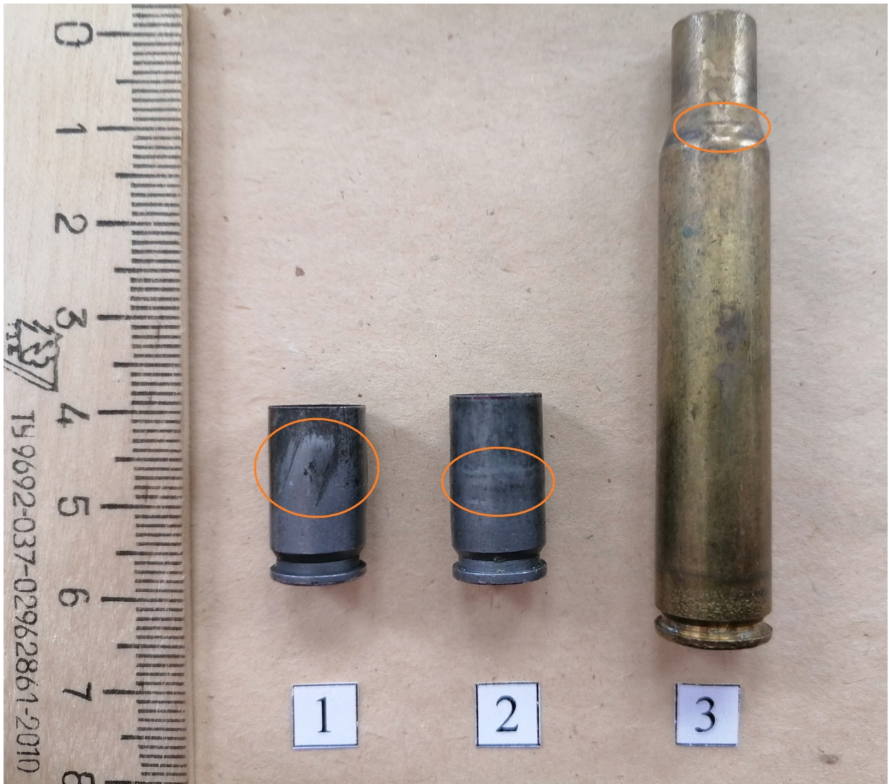
Рисунок 1. Образование следов на стреляных гильзах, от технических особенностей внесенных в патронник оружия: 1 – гильза калибра 9x18 мм стреляная из пистолета-пулемета «Клин», в патроннике изготовлена винтовая проточка; 2 – гильза калибра 9x19 мм стреляная из пистолета-пулемета «Кедр-Рага», в патроннике изготовлена кольцевая проточка; 3 – гильза калибра 30-06 стреляная из гражданского карабина «Сайга», на скате патронника выполнена выборка металла.
